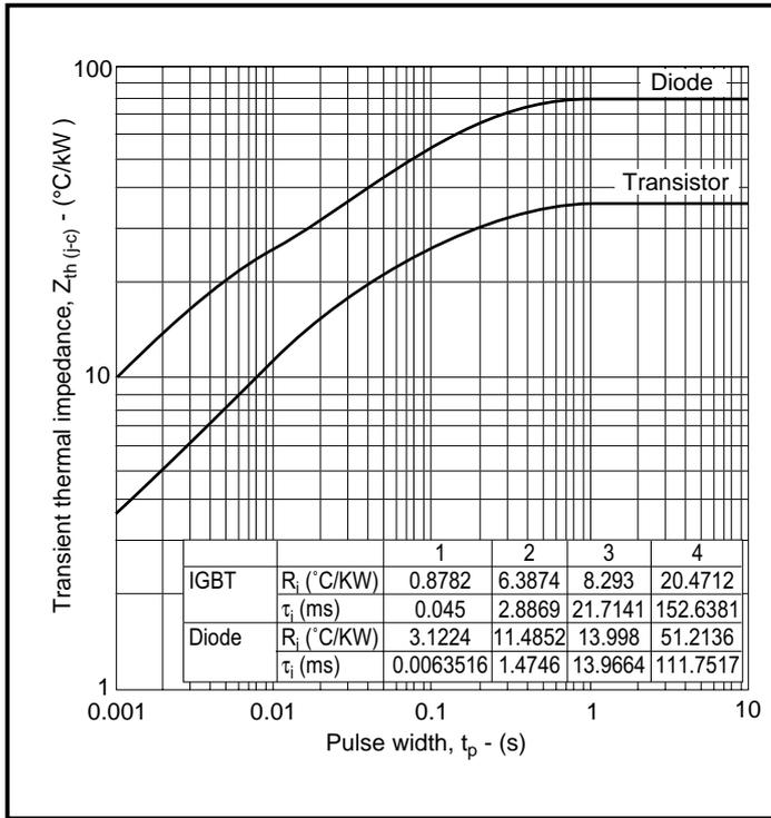
Fig. 13 Transient thermal impedance
